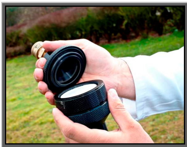
Figure 15 : Relevé d'un filtre atmosphérique par l'AFCN
